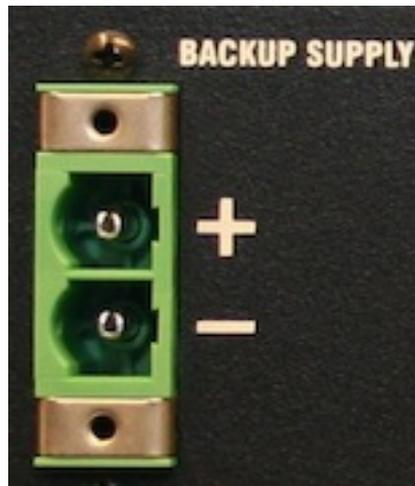
**Bild 2.3:** Eingang Notstromversorgung
