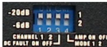
**Bild 2.13:** DIP Schalterblock
